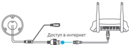
Рисунок 5-3 Подключение к роутеру
